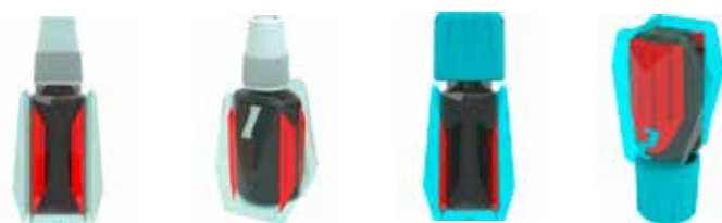
Verkleinerter Kontaktpunkt zwischen Schützhülle und Flasche
