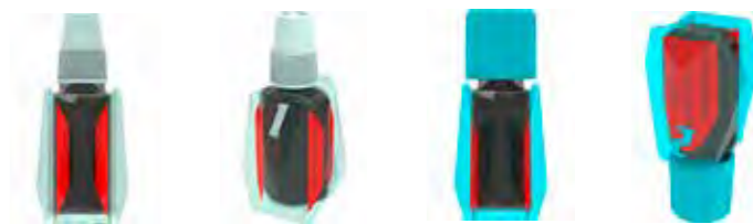
Verkleinerter Kontaktpunkt zwischen Schützhülle und Flasche
