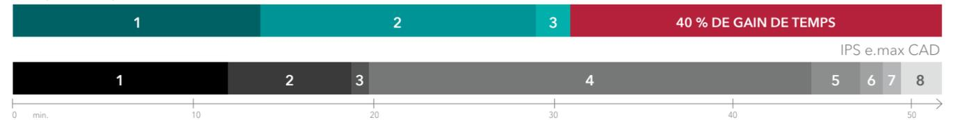
1 Fraisage 2 Pré-polissage 3 Application du putty 4 Cristallisation 5 Refroidissement 6 Retrait du putty 7 Nettoyage 8 Polissage final
