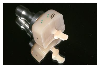
図⑦ ミリング後。小白歯のインレーであれば、5~10分で加工が可能
