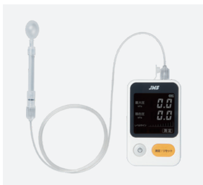
図D JMS舌圧測定器 TPM-02。
