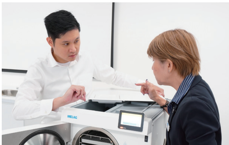
天板全体を外せるようになり、給水・排水タンクの隅々まで手が容易に届く。ただし、バキュクレープ118の上部スペースを確保しておかないと清掃は不十分となる。
