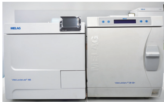
大きさや形状が比較できるようにバキュクレーブ118(左)とバキュクレーブ31B+(右)が並べて配置されていた。スタイリッシュになったバキュクレーブ118は液晶ディスプレイに目を引かれる。高さはバキュクレーブ31B+より低くなり、奥行きが少し増している。ハンドルのロック機構は軽い力で開閉できるようになった。
