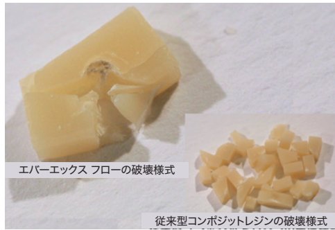
図15 各コンポジットレジンの破壊様式。
