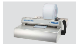
メラシールド100+ フラットタイプ 包装●1個 電源: AC100V 重量: 5.4kg 本体寸法: 幅415mm×奥行460mm× 高さ150mm シーリングシーム幅: 10mm ※メラフォルロールは製品に含まれて おりません。 ※シール可能な滅菌バッグの幅は、最 大250mmまでです。
