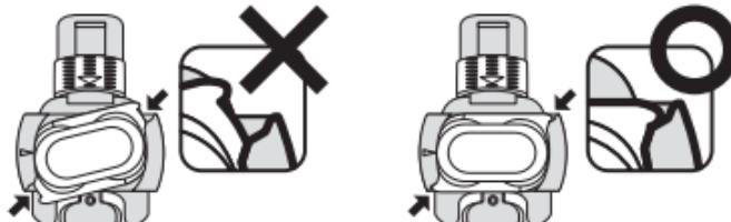
CDカートリッジは、確実にCDディスペンサーに装着してください。
