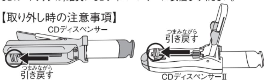
CDカートリッジの取り外し操作は、プッシュポールをCDディスペンサー本体内に完全に引き戻してから行ってください。
