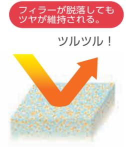
(イメージ図) 摩耗によりフィラーが脱落しても、ナノサイズであればレジジン面の凹凸が極めて小さく光沢が失われにくい。
